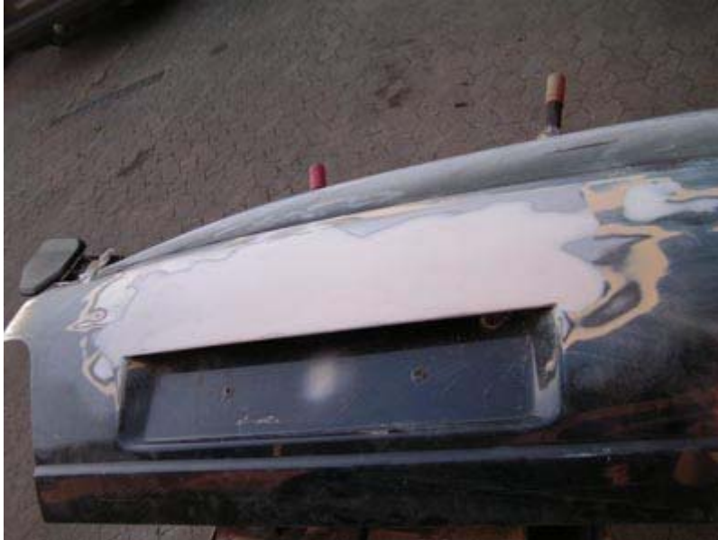
Fertig geschliffene Heckklappe
