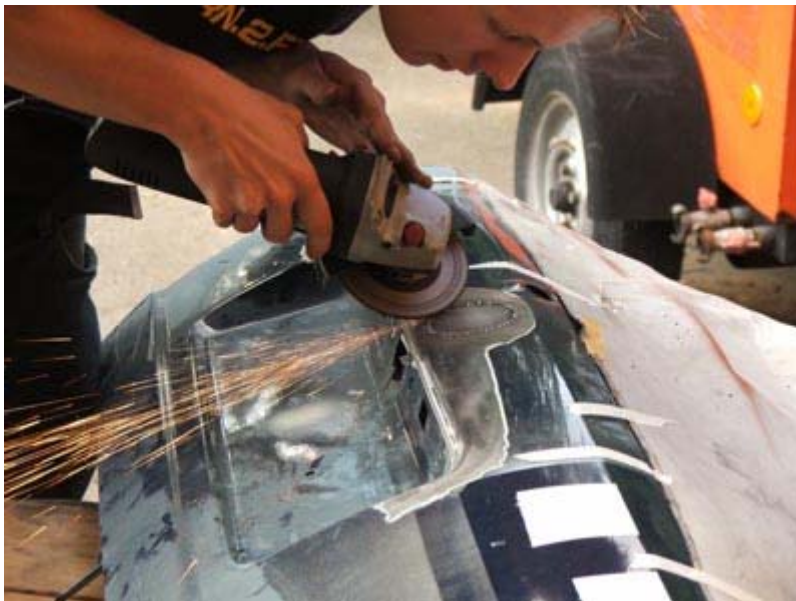
Runterschleifen der Schweißpunkte
