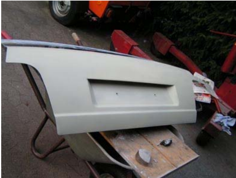
Gefüllerte & grundierte Heckklappe
