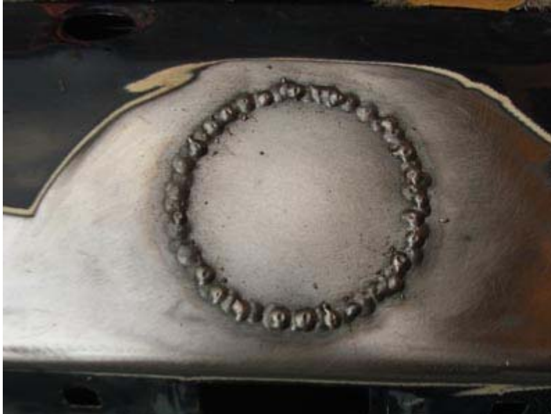
Verschweißtes und mit Drahtbürste gesäubertes Blech
