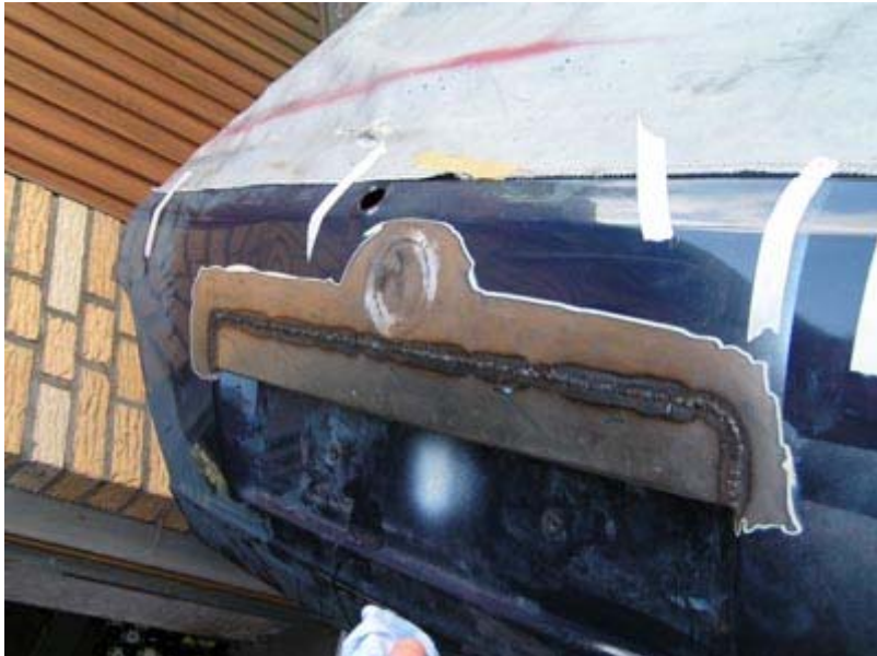
Fertig verschweißtes Leiste, sowie Emblemmulde
